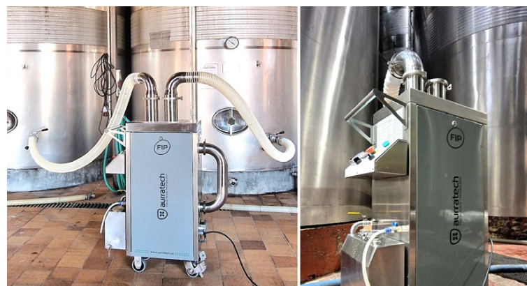
Desinfección FIP en tanque y depósito de vino en Juve & Camps y Codorníu
