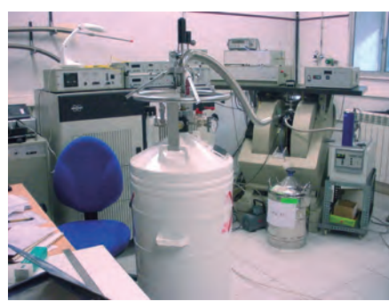
Instalación de EPR pulsado (Electronic Paramagnetic Resonance) única en España a pleno rendimiento
