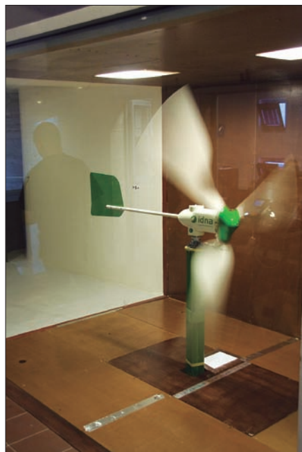
Caracterización de aerogenerador en túnel de viento del laboratorio de ensayos del ITER
